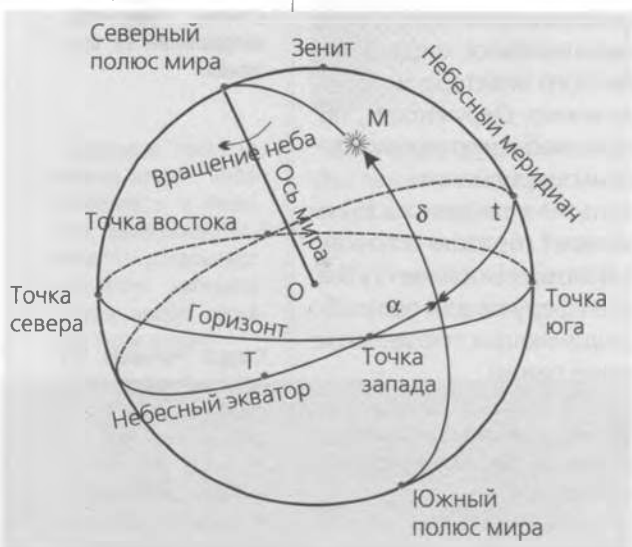
Направление отсчета экваториальных координат \alpha и \delta , а также часового угла t звезды
