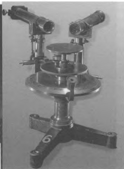
Прибор для исследования спектра светового излучения – спектроскоп, изобретенный Кирхгофом и Бунзенем
